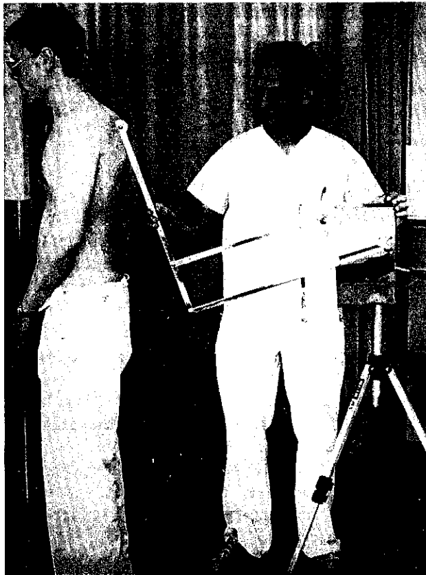
Figur 3. Spinal pantograf. Patienten står framför pantografen med en avslappad hållning och ser rakt fram. Konturlinjen av bröst- och ländryggrads-kröken överförs till ett papper av hjulet som följer spinalutskotten.
