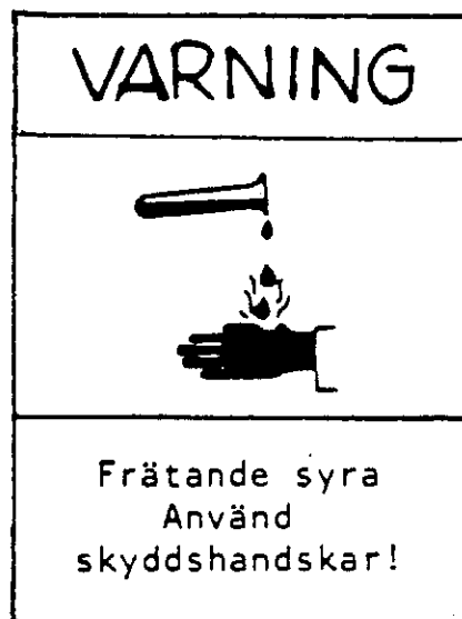
Figur 4. En bra varningsskylt kan bestå av: Markering av farans allvar, t ex med orden Fara eller Varning ; Symbol som visar farans natur; Kortfattad text som förtydligar budskapet och visar hur faran kan undvikas.
