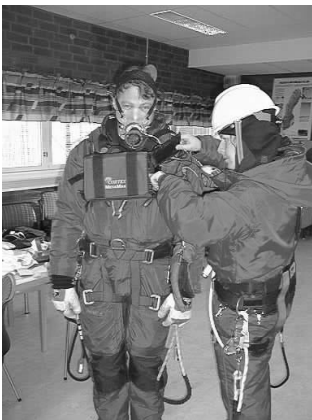
Bild 1. Utrustning för mätning av syreupptagningen sätts på försökspersonen.
