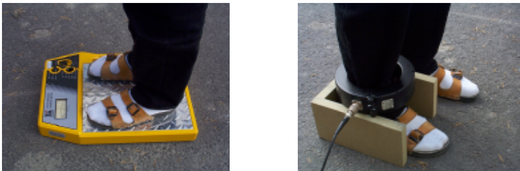
Figur 1. Vänster: Planparallell strömvåg (Holaday HI3701), höger: strömprobe (Eaton 94606-1)
