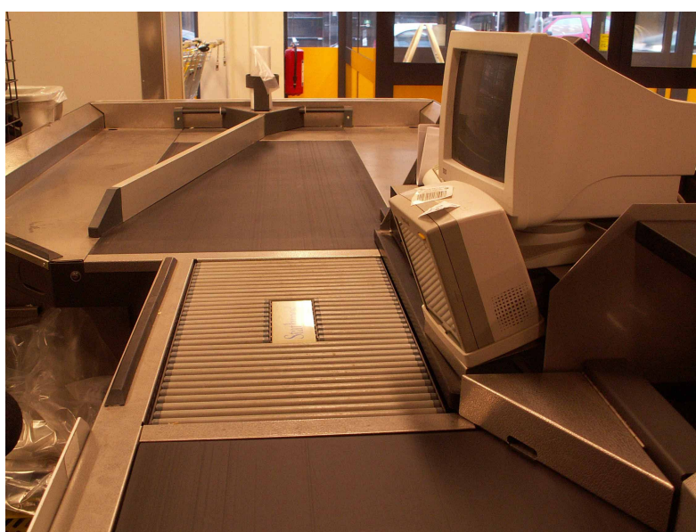
Figur 9. Kassan sett från inmatningen. Avdelaren vid utmatningen är justerbar i sidled.
