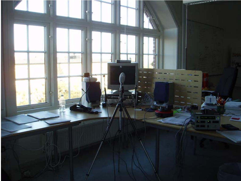
Bild 7 Mätning av det termiska klimatet i ett kontorsrum på Geocentrum I.
